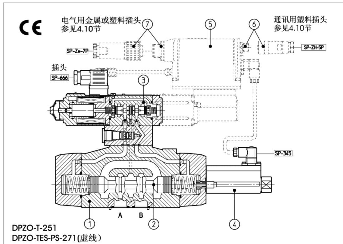
DPZO-T\*型阀是两级，主阀芯带位置传感器型比例阀，根据输入电信号的大小提供方向控制及无压力补偿流量控制。
